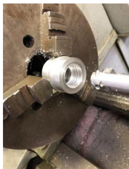
Рисунок 6. Процесс нарезания кольцевых канавок
